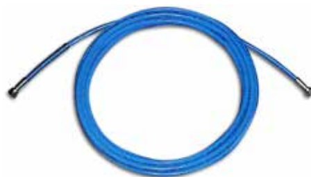
ANTIPULSATIONS 1/4" - M16X1,5 MAX PRESSURE 250 BAR
