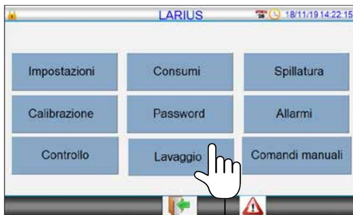
In questa pagina è possibile impostare i tempi di esecuzione dei lavaggi in funzione della configurazione della macchina, su alcune macchine è possibile avere anche un secondo lavaggio (Solv. 2) con liquido differente dal lavaggio solvente 1 (Solv. 1). In alcuni casi possiamo avere anche un soffiaggio aria tra il lavaggio Solv. 1 e il lavaggio Solv. 2.
